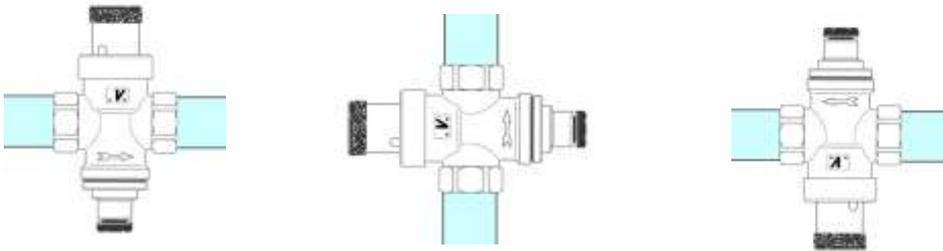
I riduttori di pressione MinibrassBlu non sono influenzati dalla forza di gravità e possono essere installati in ogni posizione:
